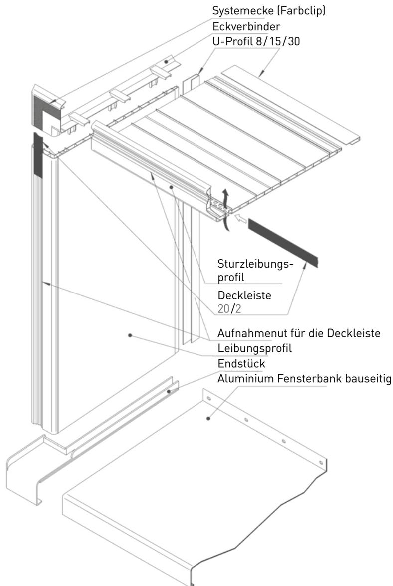
Für die Entlüftung der Fassadenfläche unter der Fensterbank muss zwischen der Oberkante des vinylBoard Profils und der Unterkante der Fensterbank ein Spalt von mindestens 5 mm belassen werden. Um Verschmutzungen der Fassadenoberfläche zu vermeiden, empfehlen wir einen Fensterbanküberstand von 3 – 4 cm und den Einbau von Fensterbankendstücken (Art.-Nr.: 0 63 60 \_\_).
