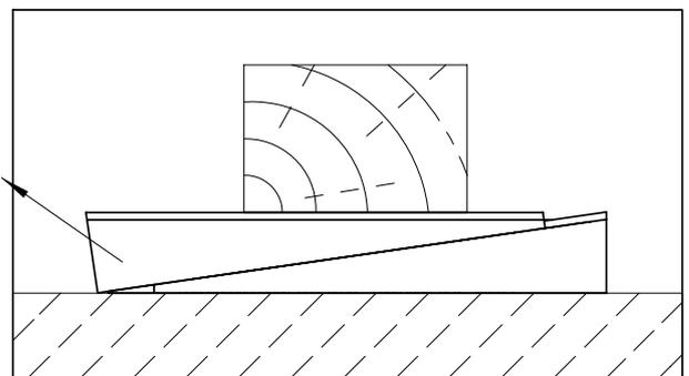
Unebenheiten einer Hauswand können mit Montagekeilen ausgeglichen werden. Verdrehungen der Latten sind dabei zu vermeiden. Wenn Fassadenprofile auf verdrehte oder unebene Unterkonstruktionen montiert werden, können Verwölbungen entstehen.
